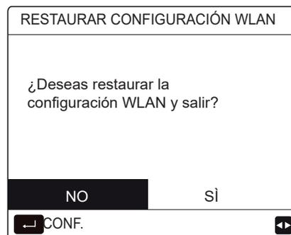
Usa "◀", "▶" para ir a "SÍ", pulsa "←" para restablecer los ajustes WLAN. Completa la anterior operación y la configuración inalámbrica se restablece.
