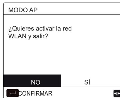
Usa "◀", "▶" para ir a "SÍ", pulsa "←" para seleccionar el modo AP. Selecciona el Modo AP según el dispositivo móvil y continúa con los siguientes ajustes según las indicaciones de la APP.
