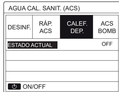
Utiliza "ON/OFF" para seleccionar ON u OFF. Utiliza "BACK" para salir.
