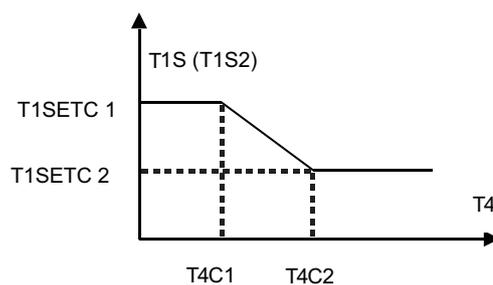
Estado: en el ajuste el controlador por cable, si  $T4C2 < T4C1$ , a continuación, intercambia su valor; si  $T1SETC 1 < T1SETC 2$ , a continuación, intercambia su valor.
